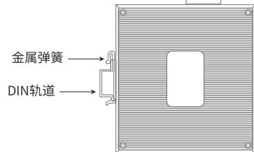
说明: 如想从交换机上移除DIN轨道, 需1. 顶部往下按压弹簧, 2. 旋转设备并移除。
