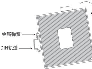
2. 将DIN导轨座单元迅速旋转按入如下图所示位置。
