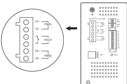
1. 将负/正DC线插入接线端子的V-/V+端子。
