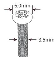
4. 在固定螺钉到墙体之前, 请通过将螺钉插入壁挂件的一个锁孔中, 确保螺钉头和柄的尺寸合适。
